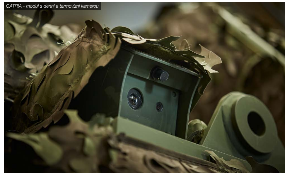
GATRIA - modul s denní a termovizní kamerou
